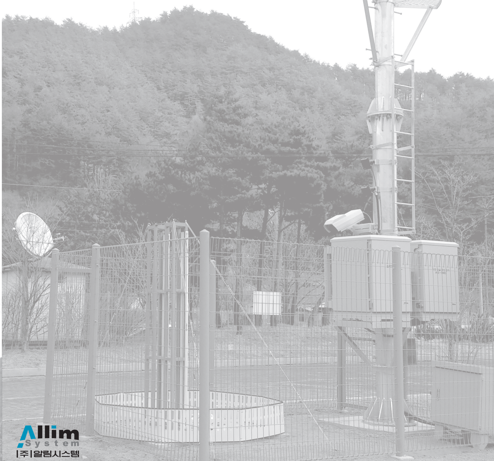
현장에 설치된 알림시스템의 자동영상적감시기
